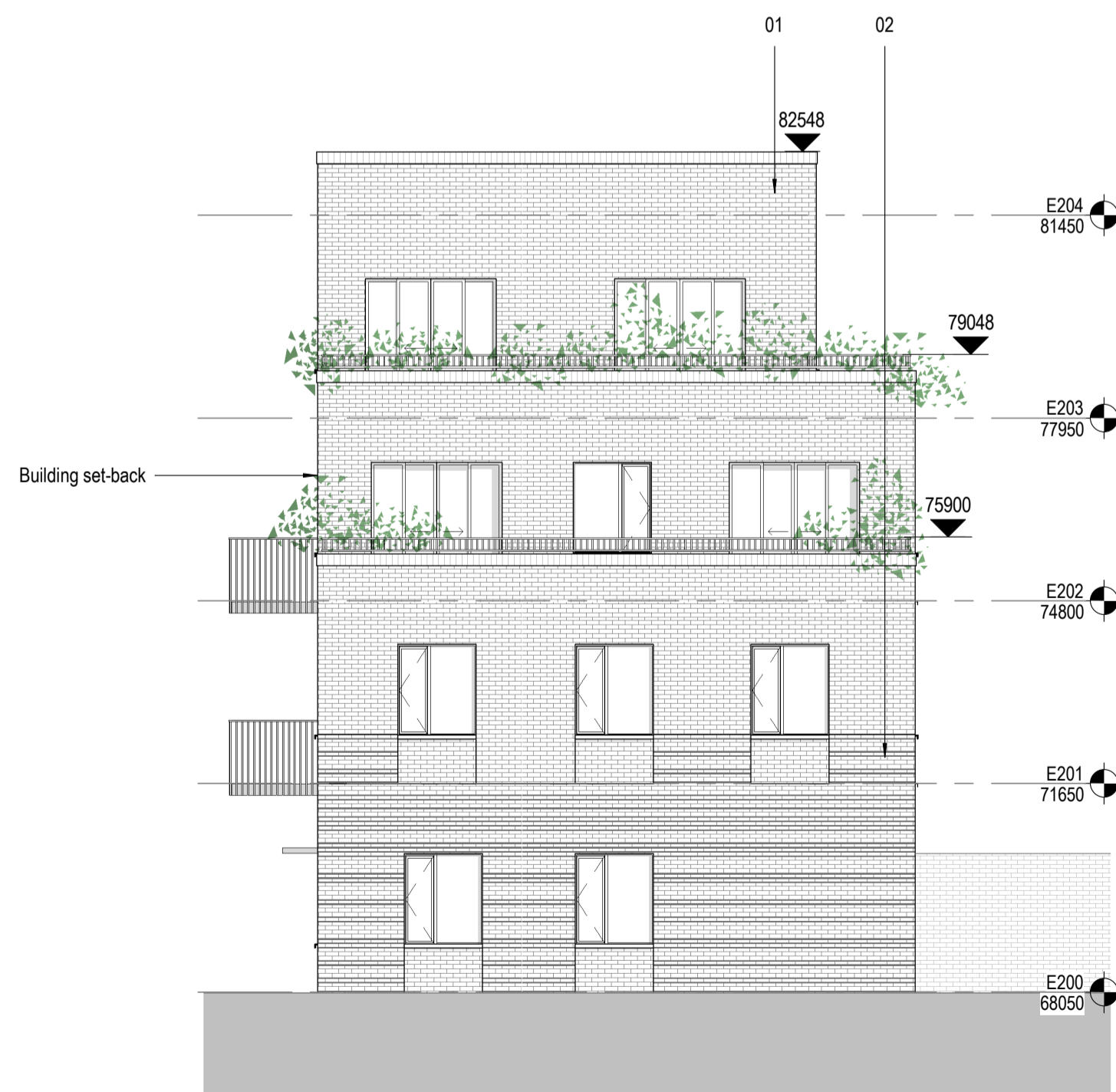
2 Block E2 - South Elevation 1 : 100
